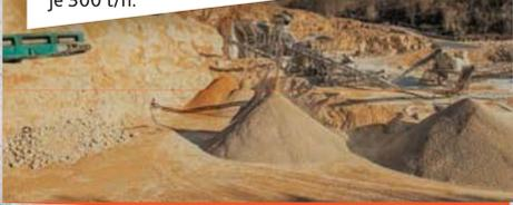
Za spravljanje betona koristimo drobljeni krečnjački agregat sa našeg kamenoloma, deklariranih frakcija, kontrolisane vlažnosti. Kompletan proces proizvodnje i kontrole kvaliteta vršimo prema važećim standardima.
