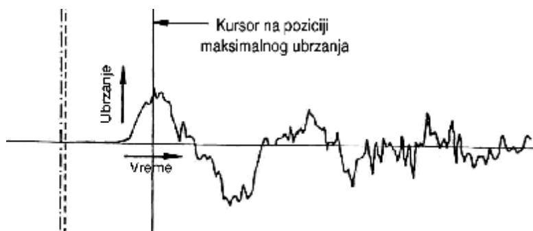
Slika 13. Tipičan dijagram promene ubrzanja udarne mase tokom vremena [22]
